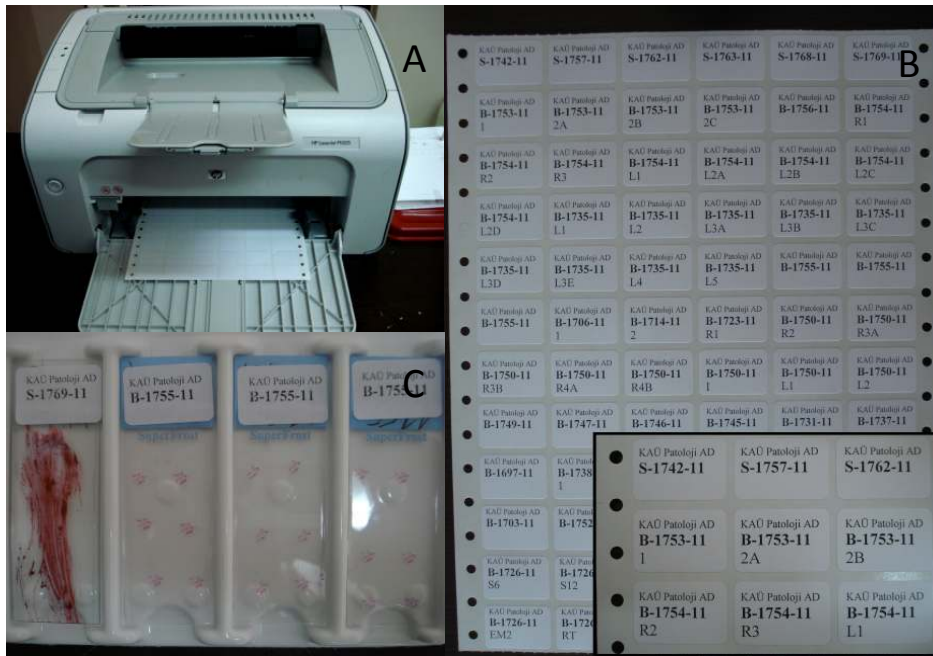
Figür 1: Lamlara etiket hazırlama süreci a) Rutin yazıcıda etiket şeridinin yerleşimi b) Etiketlerin yazıcıdan çıktığındaki görünümü c) Etiketlerin preparat üzerindeki görünümü.
